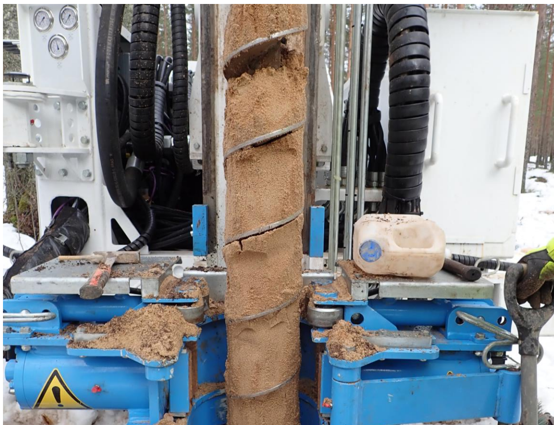
Foto 3.2 Uuringuruumi puuraugu tüüplabilõige (M. Karimov, veebruar 2019. a)
